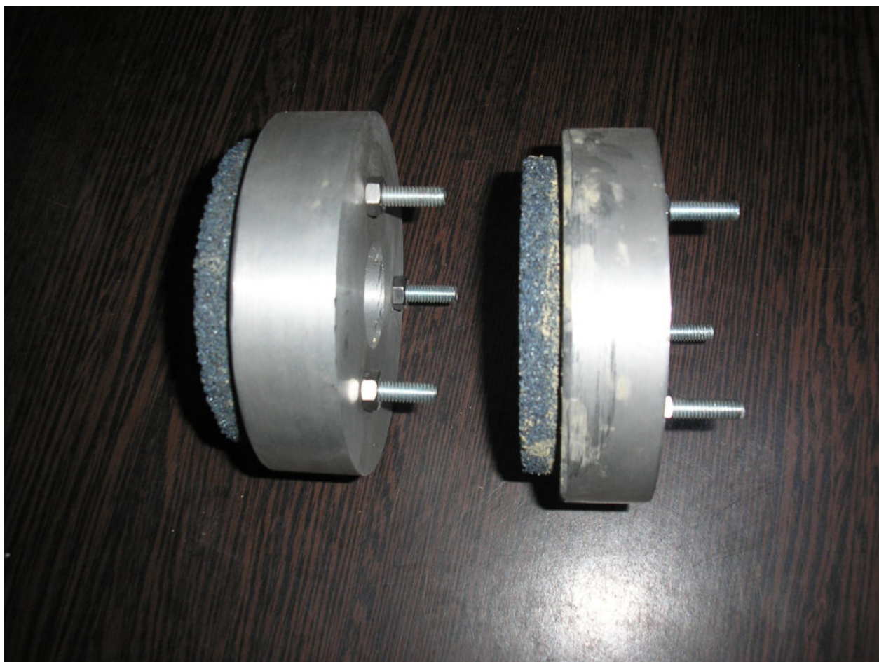
Kísérleti őrlőkő tartója és kísérleti gépben az őrlőkő elhelyezkedése
